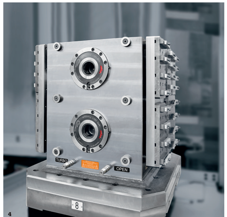
3 Aus einem Baukastensystem werden die Spanntürme bestückt. 4 Eine sehr effiziente Lösung ist die Ausstattung des Spannturms mit dem APS Nullpunktspannsystem.
